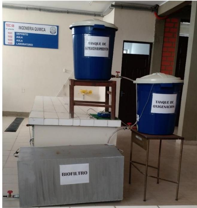
**Biofiltro con relleno de poliestireno (plastroformo particulado), puesto en celdas.**
