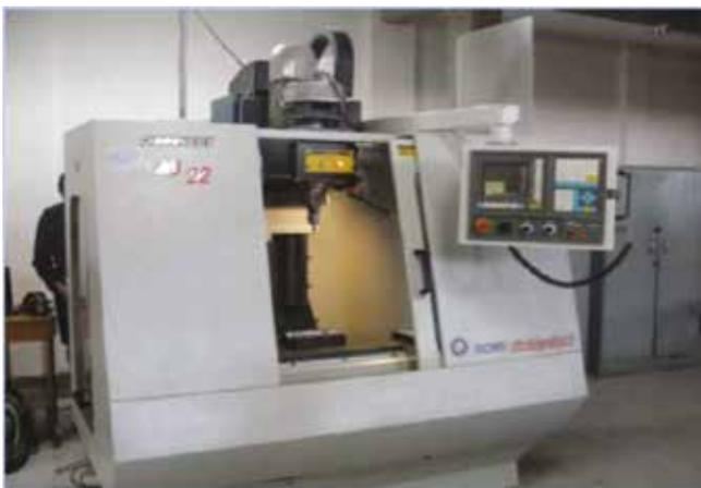
La máquina fresadora CNC Mach-9MP es capaz de hacer movimientos en sus tres ejes (x, y, z) junto a la mesa donde se encuentra el objeto metálico para hacer trayectorias tridimensionales en el fresado de un diseño complejo, los movimientos de los ejes son controlados por los cuatro servomotores que tiene el máquina. El control de la Mach-9MP es el
