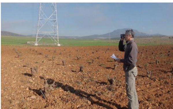
**Figura 5.** Medición de campo con distanciómetro
