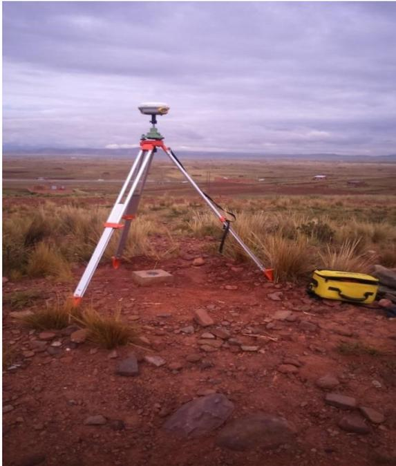
**Figura 1.** Marcado de puntos geodésicos GpsRTK
