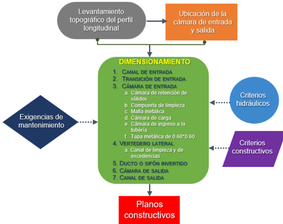
Figura 3 Secuencia metodológica y criterios para el diseño de sifones invertidos
