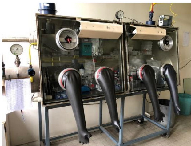
Figura 3.3 Globe box utilizado en LEPMI para el armado de pilas botón.
