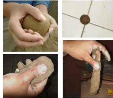
**Humedecimiento, trituración y mezcla:** Para tener un material trabajable en construcción, no debe tener terrones. La forma más sencilla a emplear para preparar la mezcla adecuadamente es remover el barro humedecido con un azadón o amasando la mezcla con los pies
