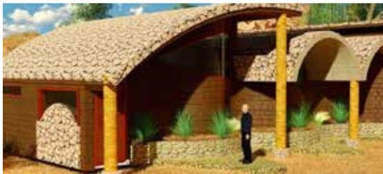
El revestimiento exterior de las bóvedas se realiza con tierra y como material impermeabilizante piedra laja, permitiéndonos lograr un integración con en el lenguaje exterior.
