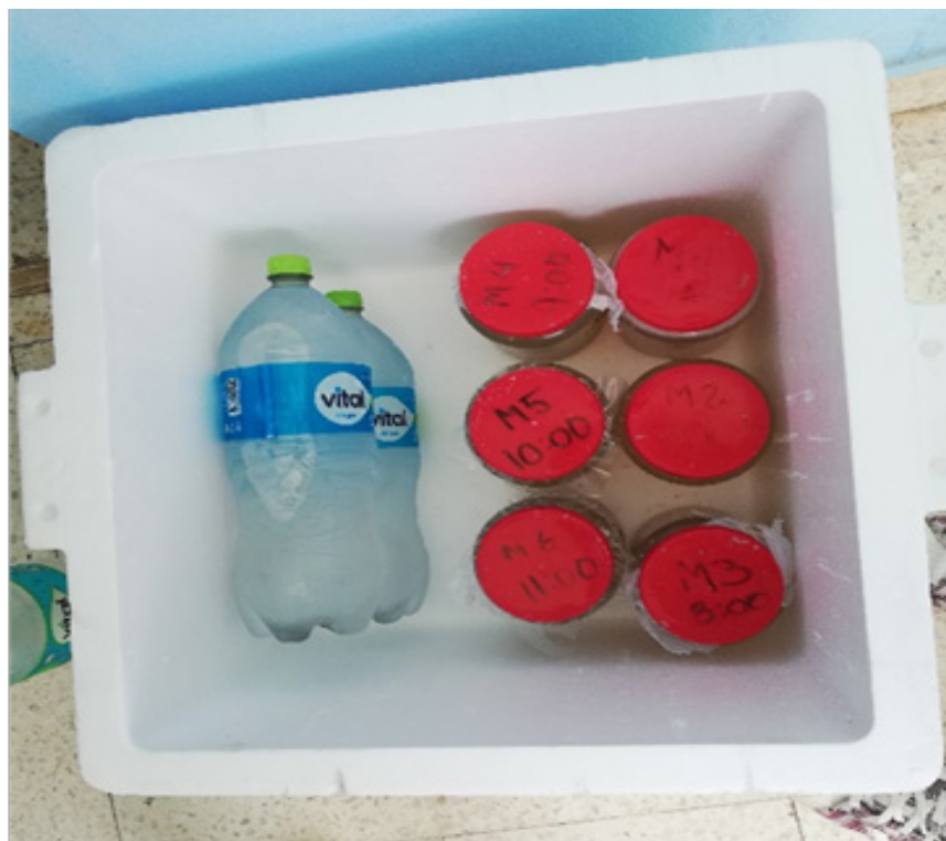
Fotografía 1. Conservación de muestras para su posterior traslado al laboratorio
