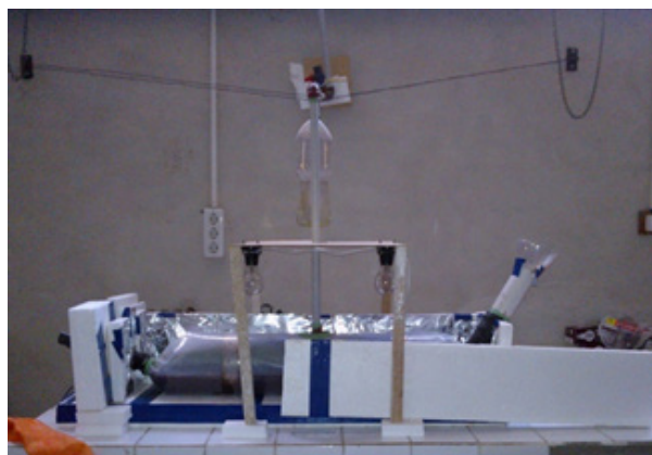
Figura 2. Biodigestor de polietileno tubular experimental.
