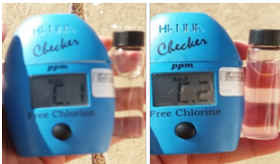
Fotografía 1. Lectura del Valor de Cloro Residual
