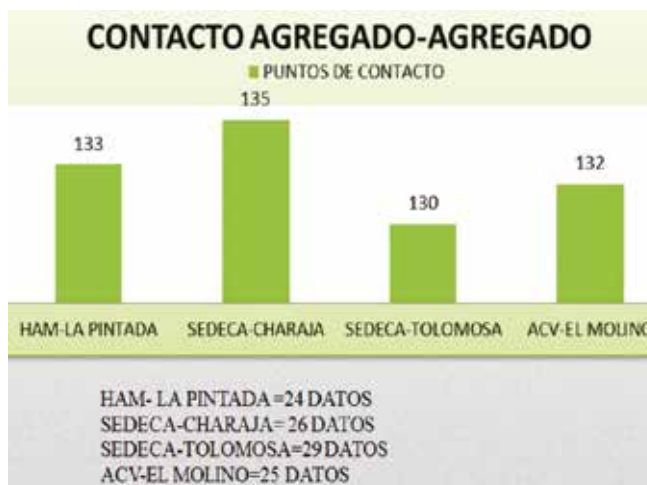
Figura 3. Contacto agregado-agregado de mezclas analizadas
