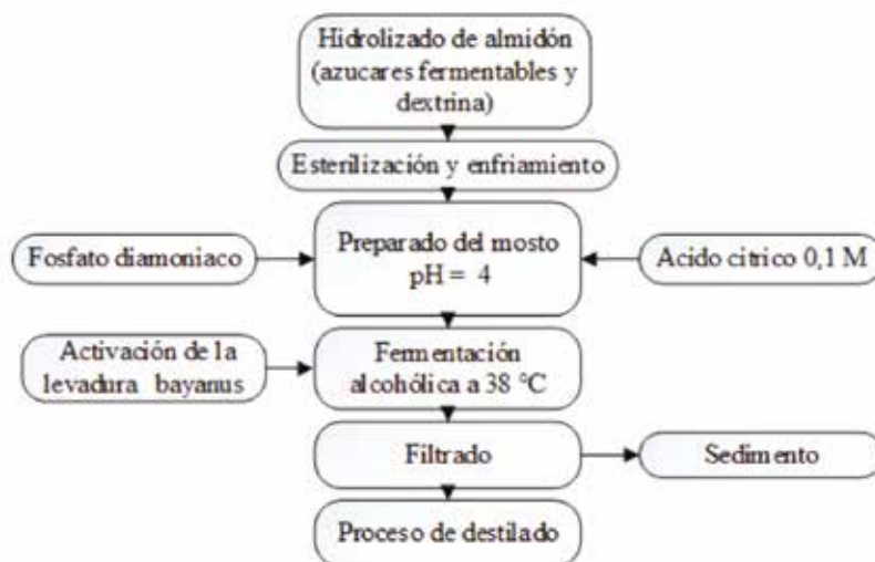
Figura 4. Diagrama de bloque del proceso de fermentación alcohólica y destilación
