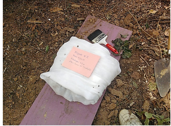
Figura 7. Muestras remodeladas de suelos
