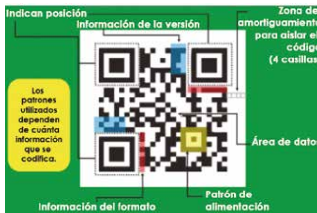
Figura 2: Componentes del código QR
