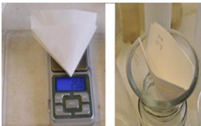
Figuras 8 y 9. Pesaje del Papel de filtro utilizado para cada ensayo.
