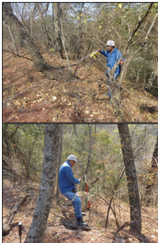
Figura 5. Delimitación de la parcela, con jalón, GPS y wincha
