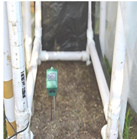
Figura 5. Microparcela sin cobertura, con sensor de humedad
