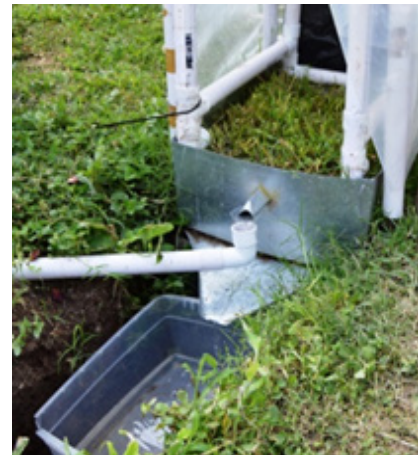
Figura 4. Microparcela con cobertura de pastizal natural, con 2 colectores.
