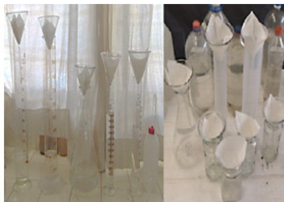
Figura 10. Equipos para la filtración del agua de los escurrimientos.
