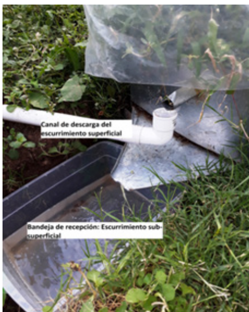
Figura 6. Colecta de escurrimientos superficial y sub-superficial.
