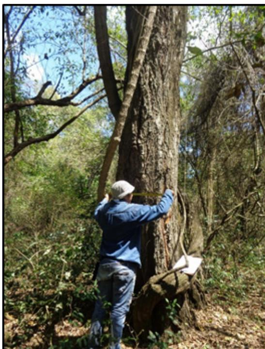
Figura 6. Medición del diámetro a 1.30 m de Altura.
