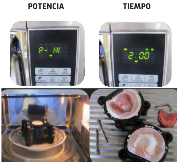
Figura 14: Eliminación de cera en el horno de microondas 1° fase
