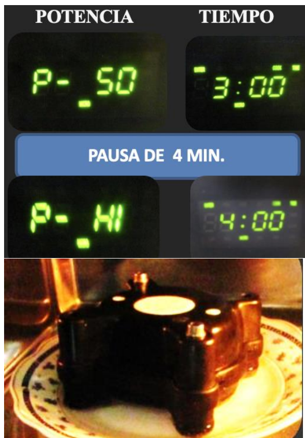
Figura 29: Proceso de acrilizado en el horno de microondas: potencia - tiempo
