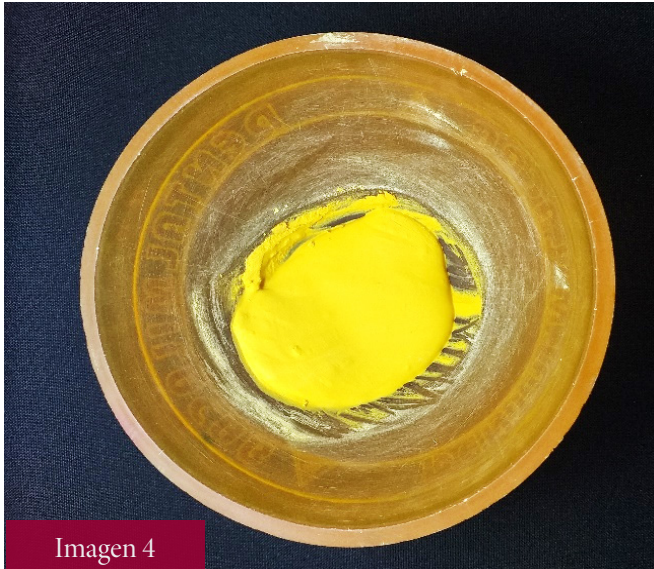
Imagen 4 Tiempo de fraguado inicial (La pérdida de brillo indica el tiempo de fraguado inicial)
