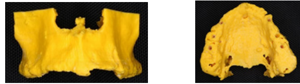
Fig 5 y 6 Biomodelo construido con tecnología FDM. Material A.B.S. Fuente: Propia
