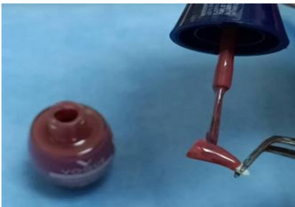
Imagen 12: Recubrimiento con barniz
