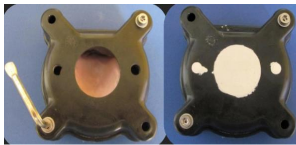
Figura 13: Cierre de la mufla y llenado con yeso piedra extraduro.
