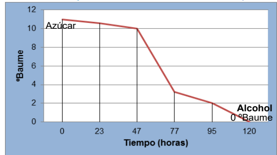
Figura 7 Control de los °Baumé para el recipiente 4 en el proceso de fermentación con orujo.
