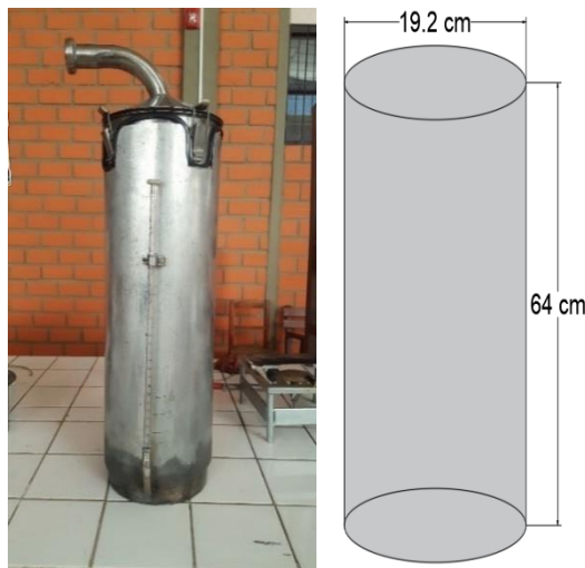
Fotografía 2- 3 Torre de Extracción, Dimensionamiento
