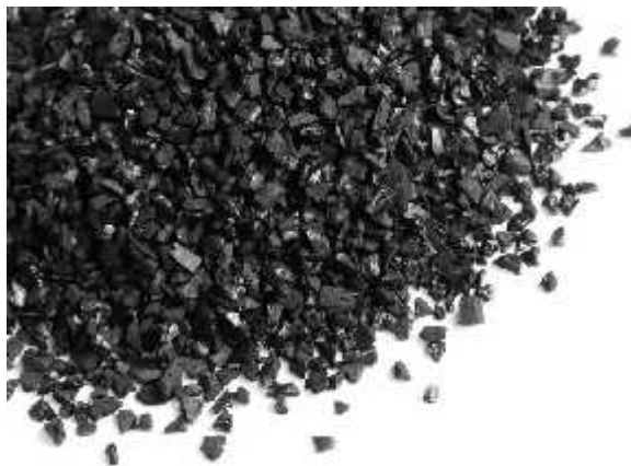
Figura 2-9. Carbón activado granular
