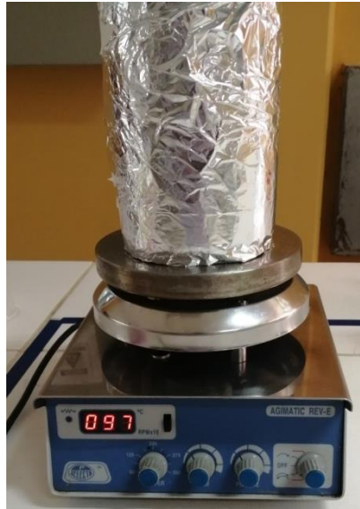
Fotografía 3- 4 Extracción del colorante natural, mediante agitación
