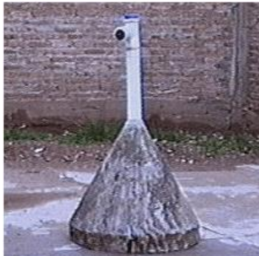
Figura V-9. Separador GSL (Gas-Sólido-Líquido)
