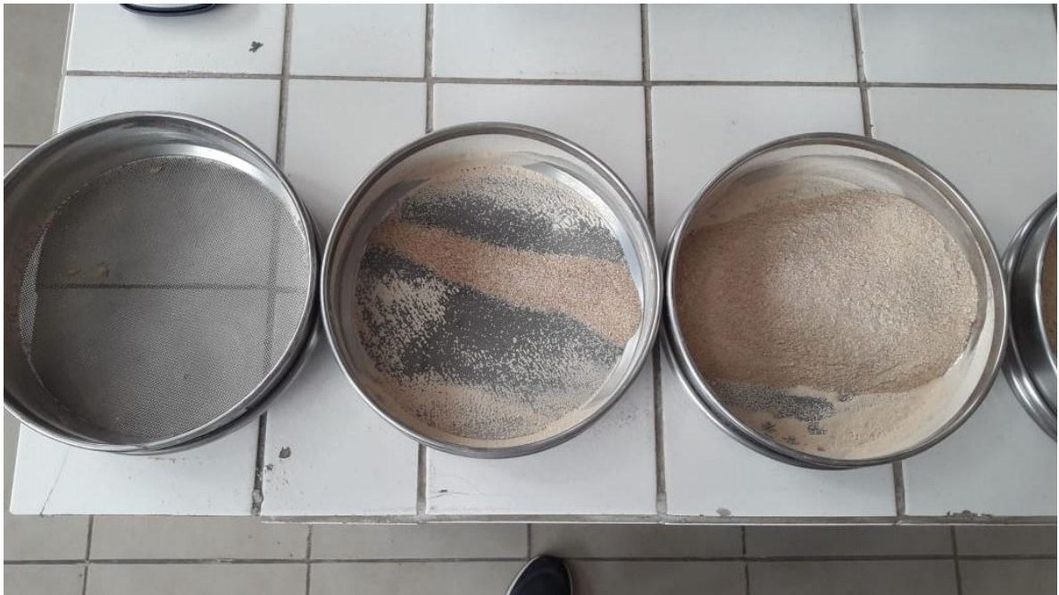
Figura 3-13 Tamizado de la cebada molida precocida
