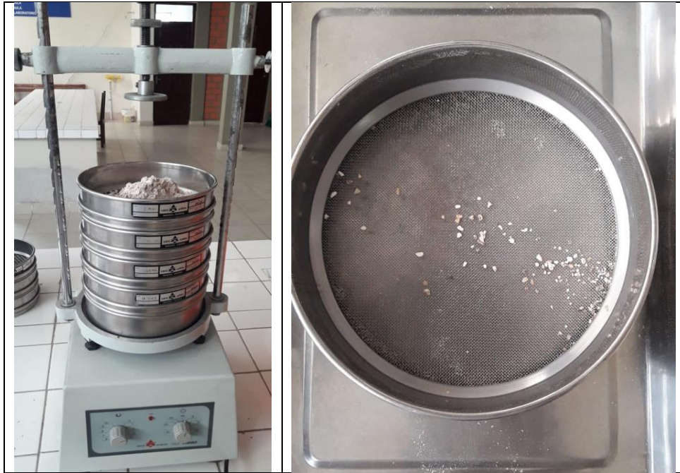
Figura 3-10 Tamizado del maíz molido precocido
