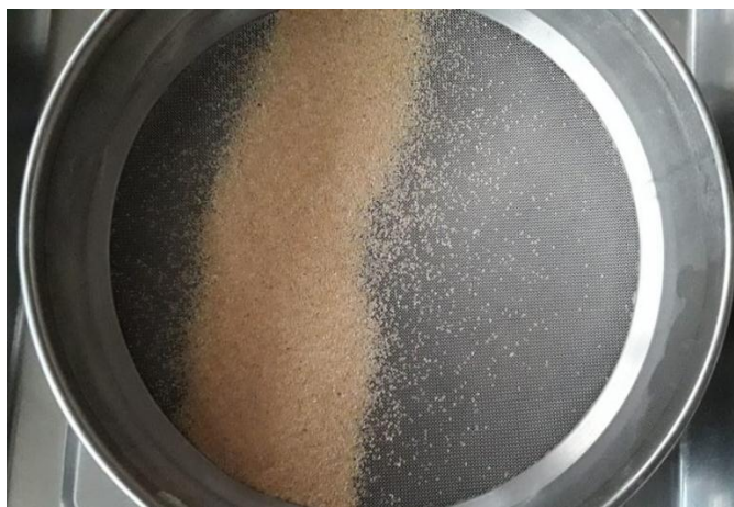
Figura 3-16 Tamizado de la arveja molida precocida
