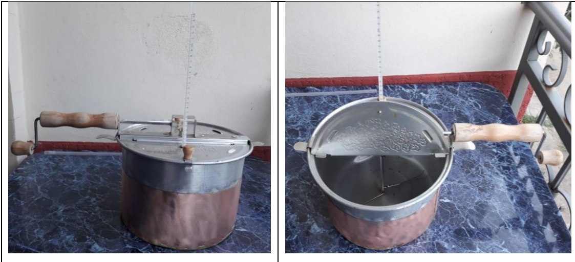
Figura 3-5 Tostador de granos acondicionado
