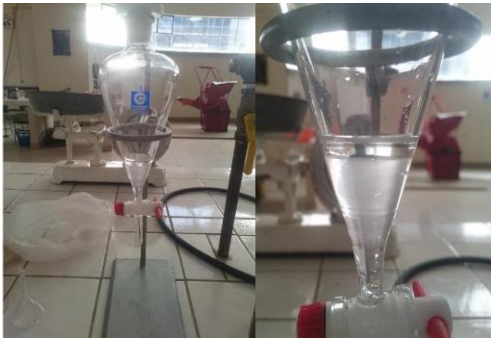
Figura 2-12 Separación de las fases agua-aceite.
