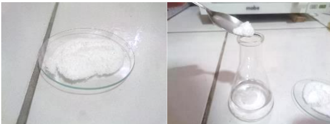
Figura 2-13 Deshidratación del aceite esencial de cáscara de mandarina
