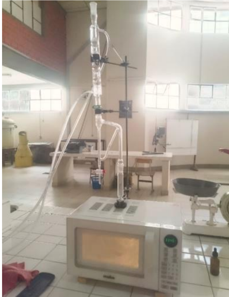
Figura 2-9 Equipo montado en laboratorio para realizar hidrodestilación asistida por microondas.
