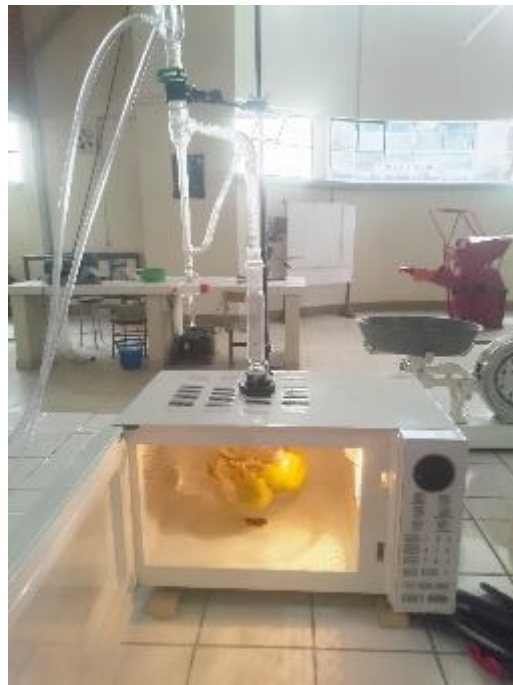
Foto F – 6 Proceso de hidrodestilación asistida por microondas
