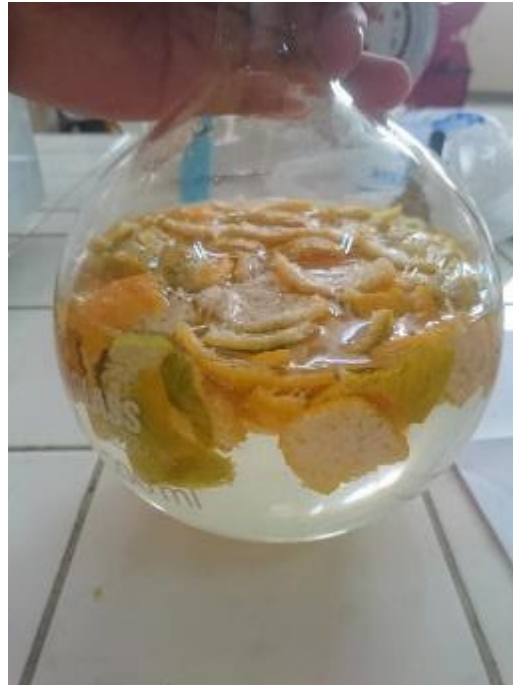
Foto F – 5 Carga de cáscara y agua
