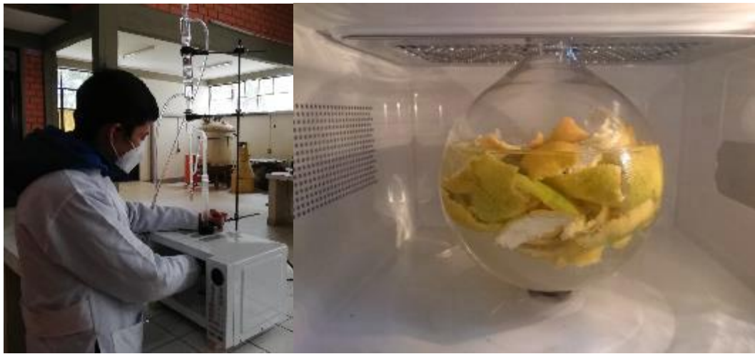
Figura 2-10 Instalación del equipo de hidrodestilación asistido por microondas.
