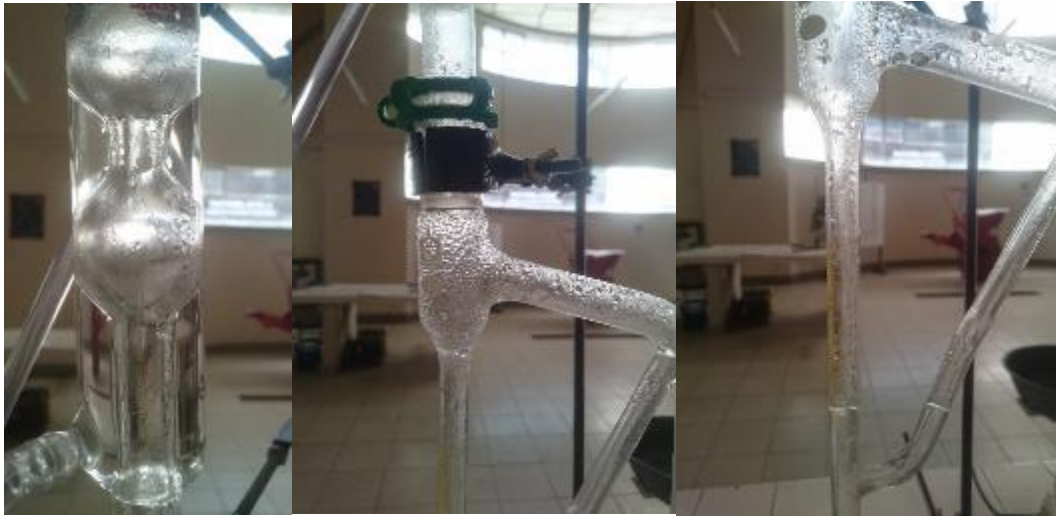
Figura 2-11 Condensación del aceite esencial de cáscara de mandarina.
