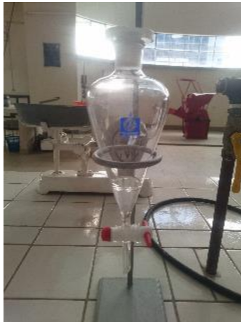
Foto F – 8 Separación del agua destilada y el aceite esencial obtenido
