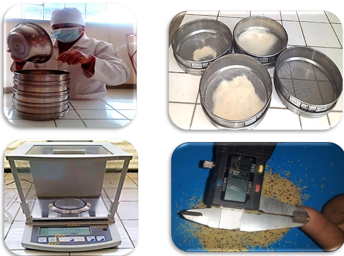
Figura 2-21 Determinación de las propiedades físicas de los granos de amaranto.
