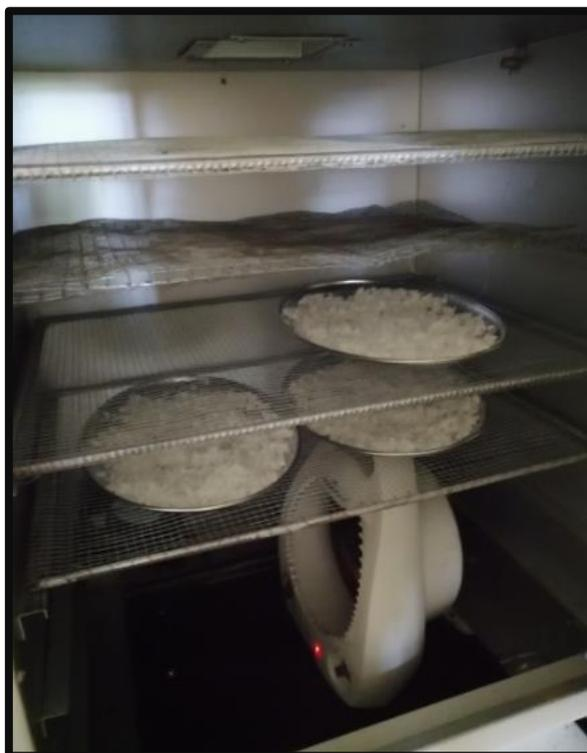
7. Pesado continuo de la pulpa de coco deshidratada hasta obtener una humedad de muestra de 3% y 10%, por medio del método gravimétrico, es decir se calcula la humedad que ha perdido la muestra mediante peso de las bandejas con muestra.
