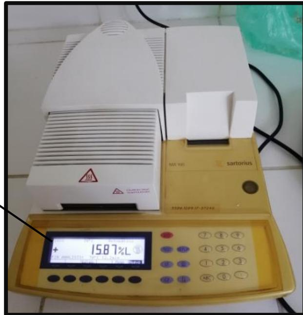
De acuerdo al método gravimétrico empleado anteriormente mediante secado en estufa y pesado de muestras, la humedad de las partículas de 2mm y 5mm debiera ser de 3% para ambas y 10% también para ambas de acuerdo al diseño factorial planteado, pero ya que en la muestra fresca inicial molida se encuentran partículas de varios diámetros esta etapa de determinación de humedad total posterior al tamizado es necesaria para el ajuste de humedad requerido de la muestra a 2mm y 5mm de diámetro.
