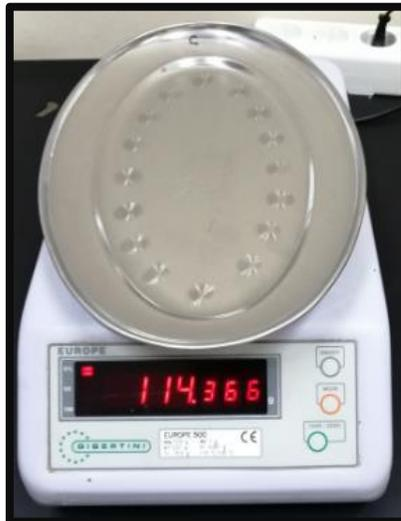
4. Una vez molida la pulpa de coco fresca, se toma una pequeña muestra de 2 gramos de la misma y se lleva a una termo-balanza en la cual se identificará el porcentaje de humedad total de ésta (muestreo).
