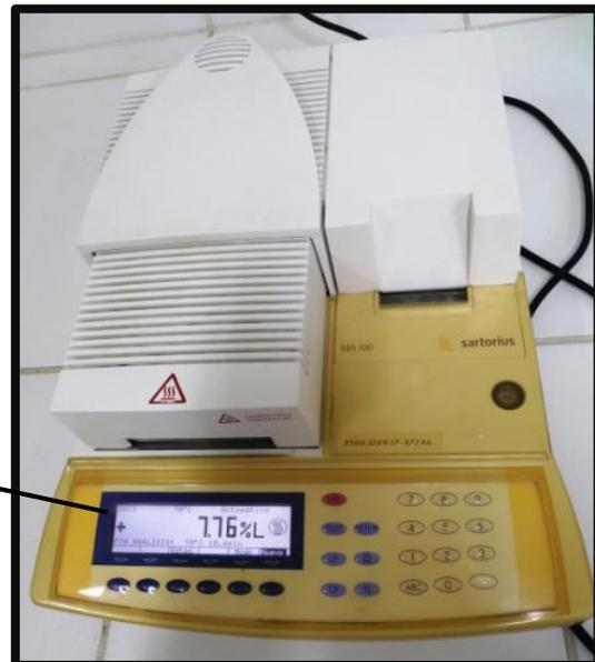
Humedad total de las partículas de 2mm después del secado en estufa y tamizado.
