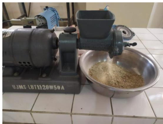
Figura 2-7 Molido del camote comestible seco en molino de rodillos
