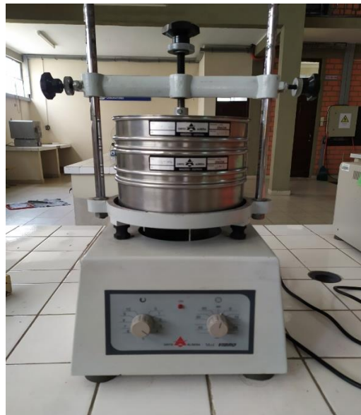
Figura 2-9 Tamizado del camote comestible seco molido
