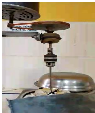
Fuente: Elaboración propia, 2021 Figura 2-11 Etapa de licuefacción
