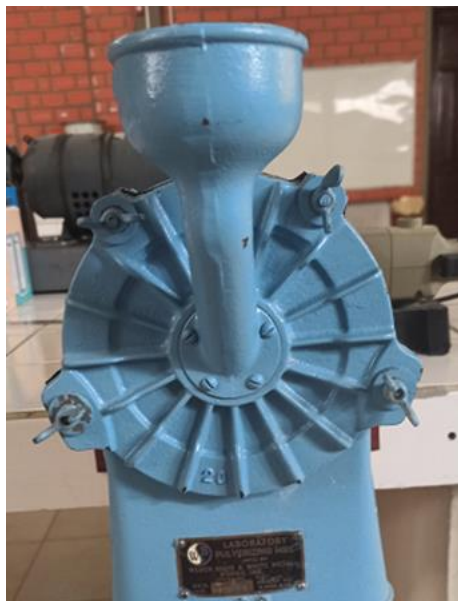
Figura 2-8 Molido del camote comestible en molino de martillos
