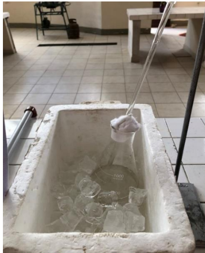
Figura 2-23 Condensado de la mezcla aceite esencial - hidrolato.
