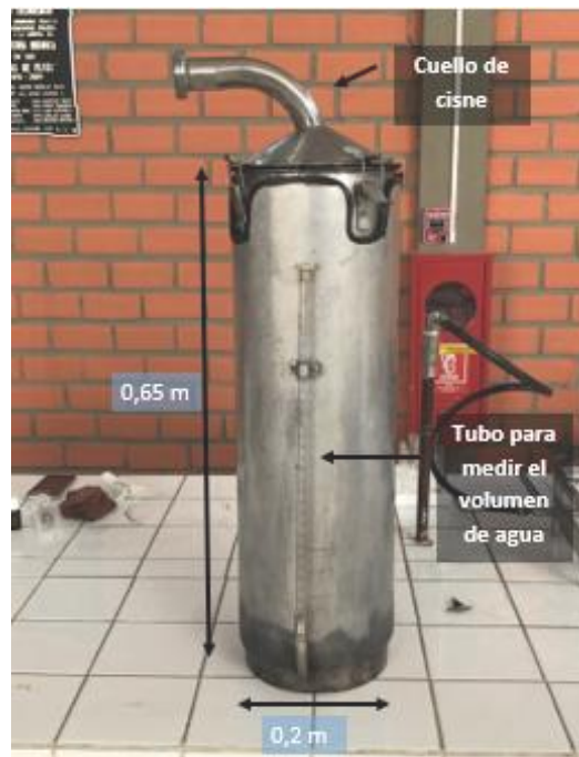
Figura 2-15 Torre de extracción.
