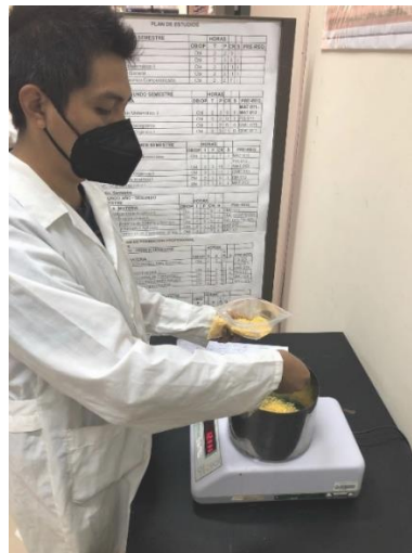
Figura 2-18 Carga de la materia prima en el canastillo.
