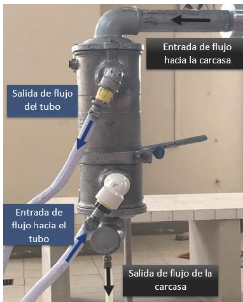
Figura 2-21 Intercambiador de calor.
