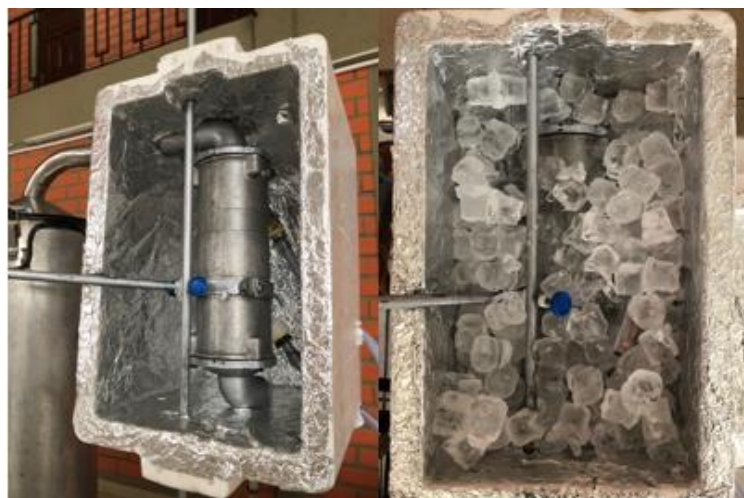
Figura 2-22 Modificación en el intercambiador de calor.
