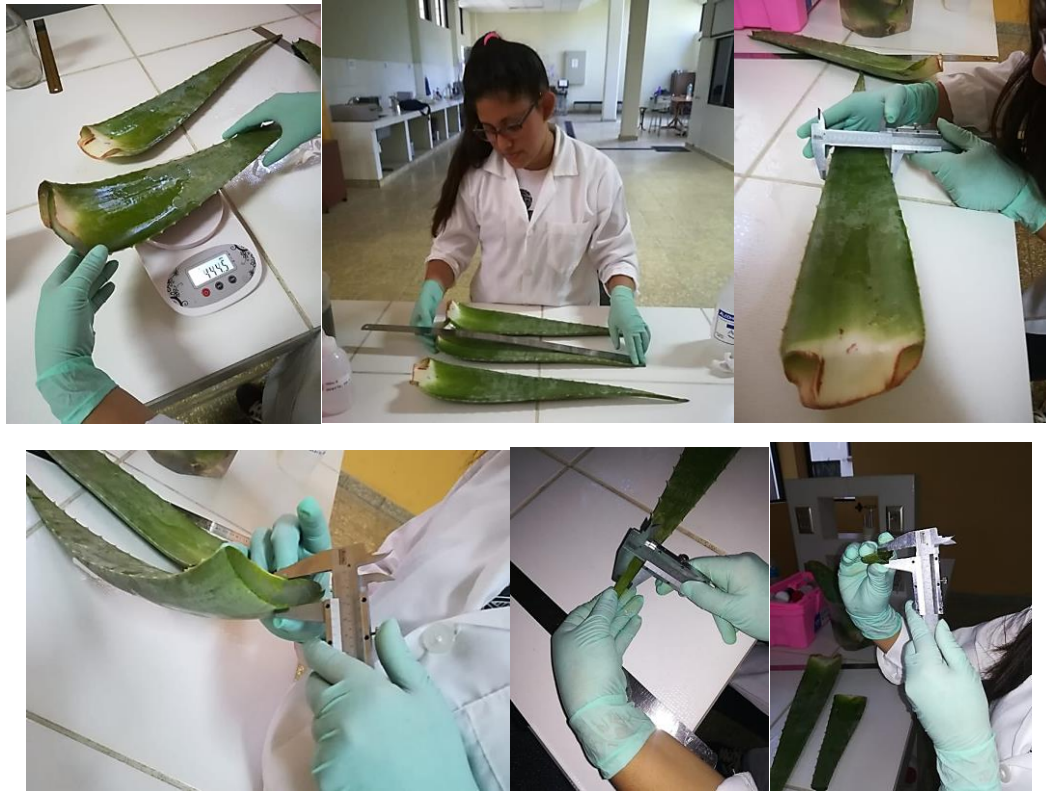
Fig 3-17 Pesaje y dimensionamiento de la materia prima
