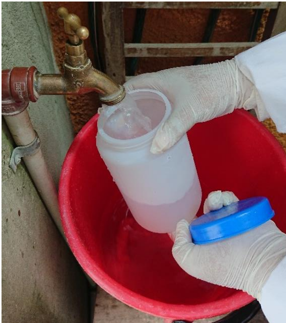
Imagen C-3. Toma de muestra de agua para análisis microbiológico
