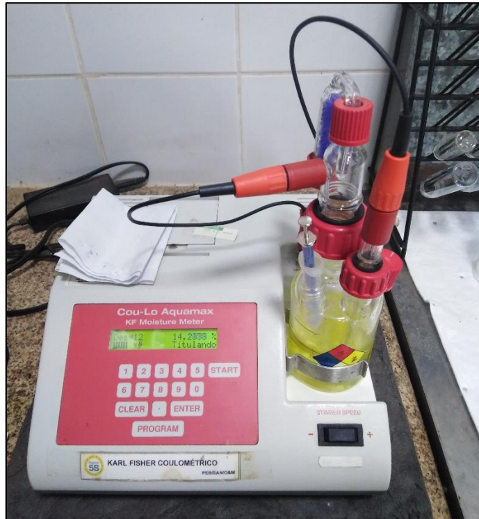
Fig. 3- 2 Determinación de Concentración de Glicol mediante KARL FISHER COULOMÉTRICO
