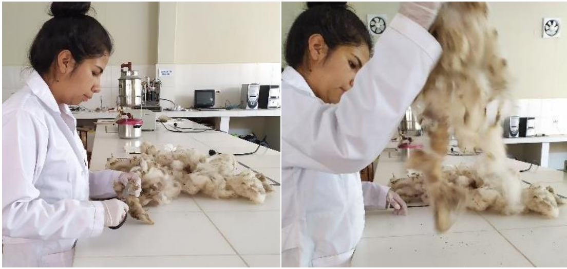
Fotografías F-4, F-5 Separación de impurezas en la etapa de limpieza de la materia prima
