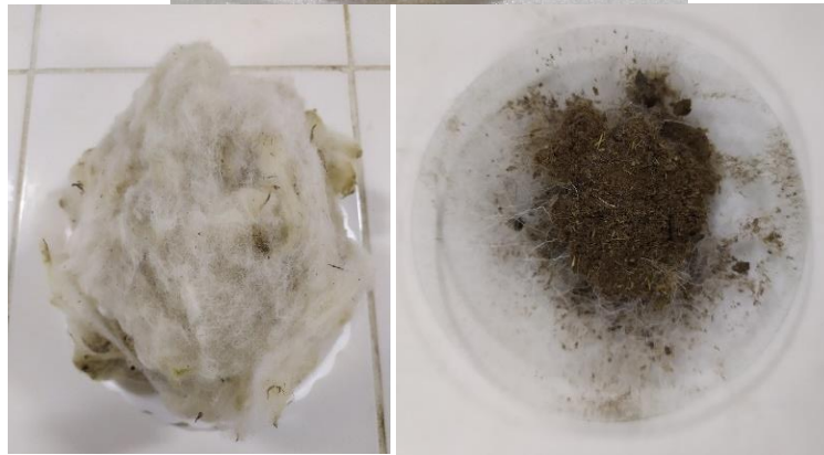
Fotografías F-24, F-25, F-26 Lanolina cruda, Lana desengrasada - espolvoreada y Polvo de Lana
