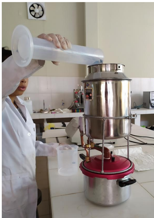
Fotografía F-15 Adición del solvente (Etanol)
