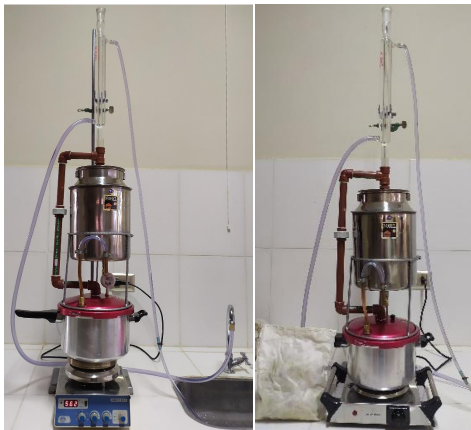
Fotografía F-17, F-18 Etapas de extracción y destilación
