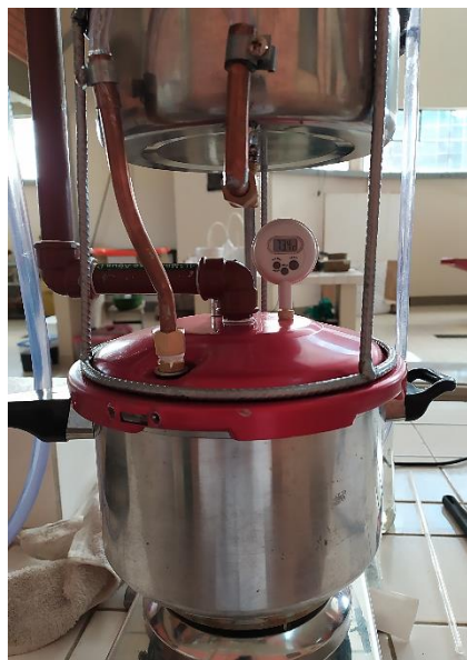
Fotografía F-16 Control de la temperatura de ebullición del solvente
