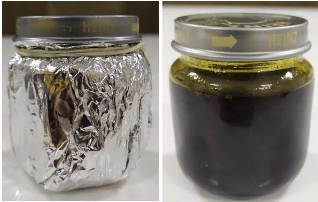
Fotografía F-31, F-32 Lanolina Cruda almacenada en frascos de vidrio herméticamente cerrados y cubiertos de la luz con papel aluminio
