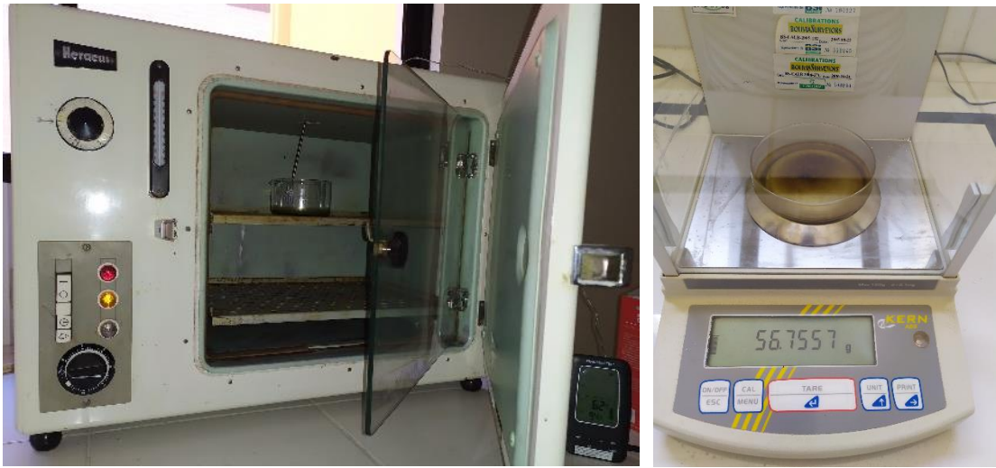
Fotografía F-20, F-21 Eliminación de las trazas de solvente en el extracto de Lanolina cruda y posterior pesaje para cálculo de rendimiento
