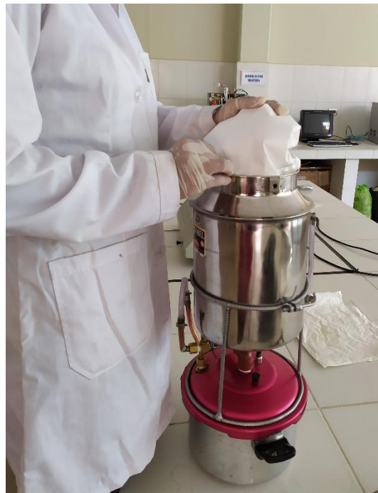
Fotografía F-14 Introducción del cartucho (con la muestra de Lana) en el extractor
