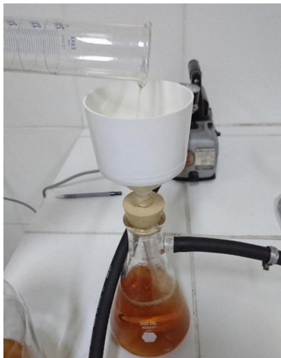
Fotografía 3- 10 Filtración a Vacío
