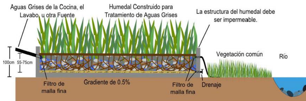
Figura 2-6. Sistema Subterráneo Típico de Humedales Construidos. (Salas, 2013)
