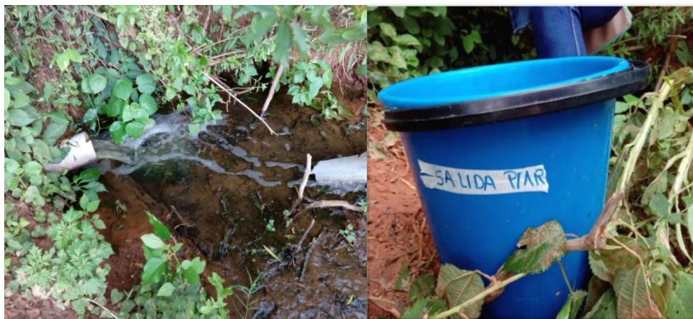
Foto 2-16. Toma de Muestra a la Salida de la PTAR. Elaboración Propia
