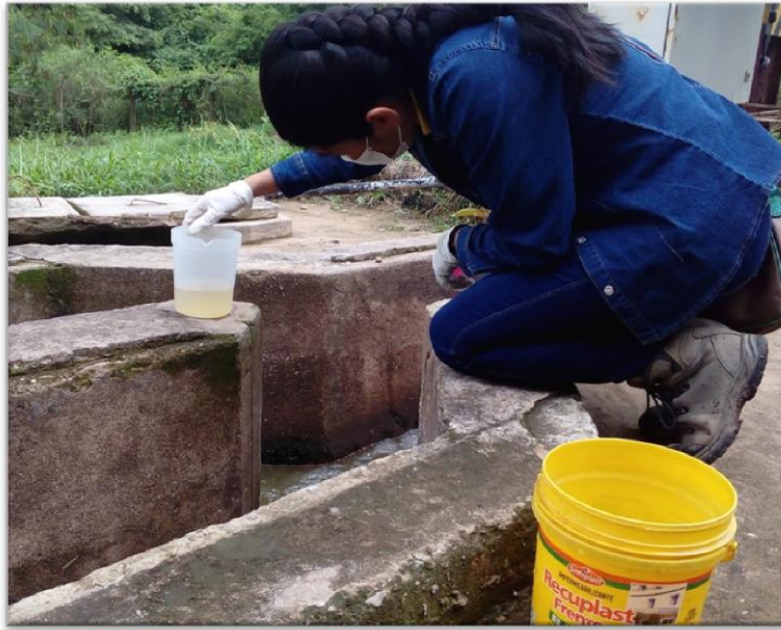
Foto 2-15. Toma de Muestra a la Entrada de la PTAR. Elaboración Propia
