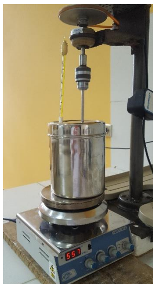
Figura 4-10 Sistema de extracción de cera cruda
