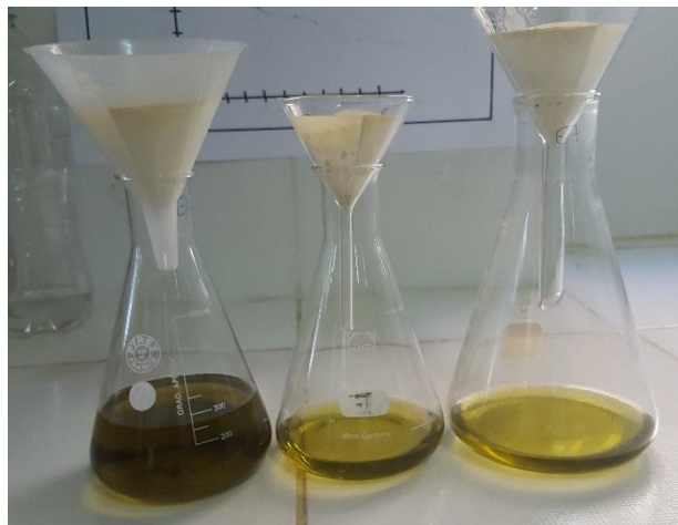
Figura 4-18 Filtración de la solución solvente - aceite
