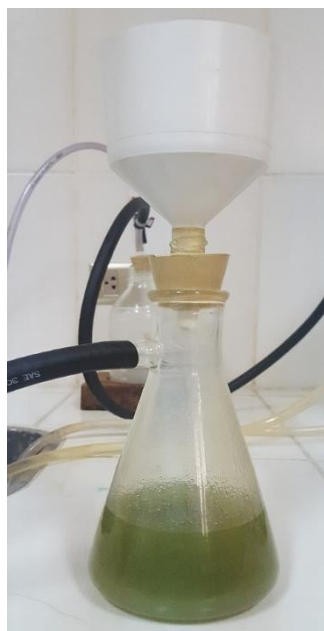
Figura 4 -22 Filtración de la solución cera – solvente
