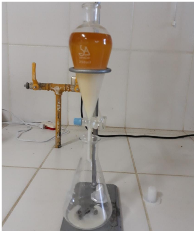
Figura 3- 6 Lavado del biodiesel
