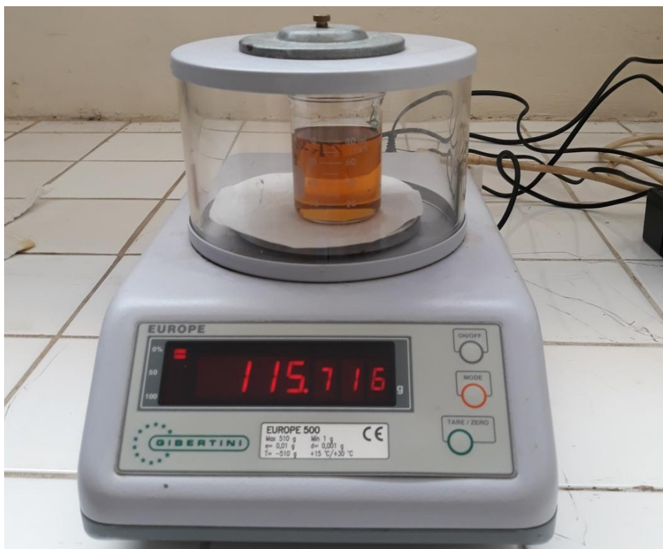
Foto 9.-Pesado de muestra de biodiesel en la determinación de humedad.
