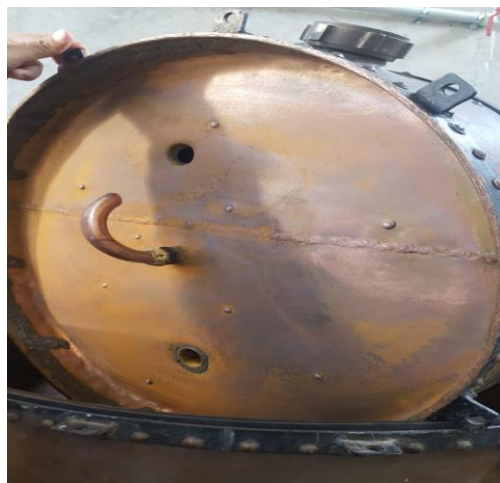
Figura 3- 1.- Plato de rectificación del alambique en la industria artesanal CAÑA REAL
