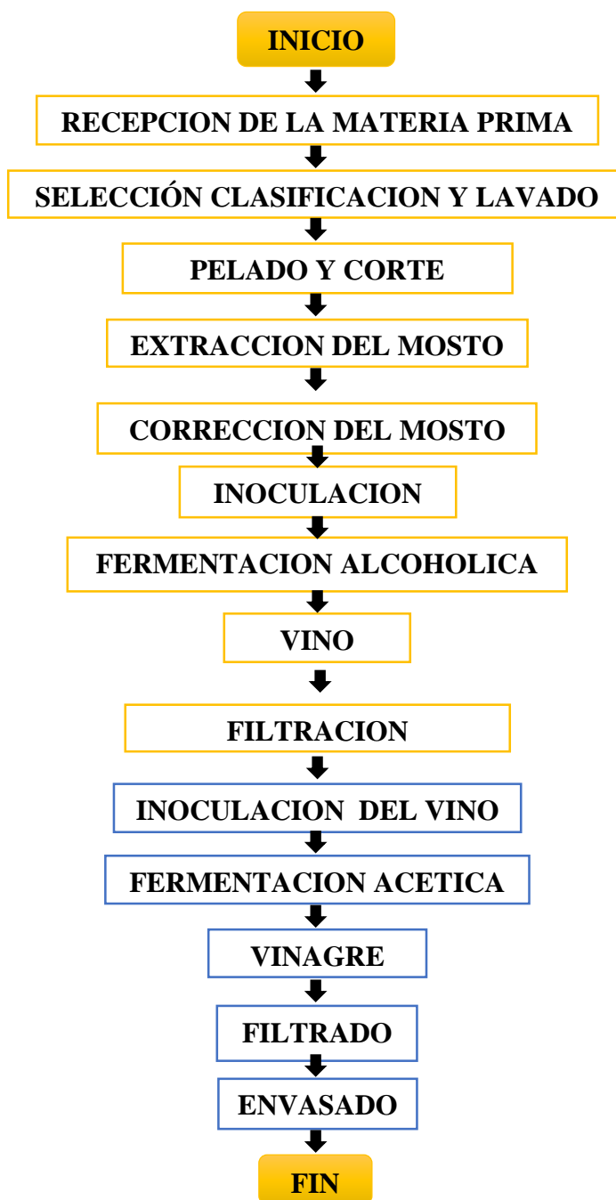
Diagrama de flujo III-1 Proceso de obtención de vinagre de mango rosa ( Mangifera indica L.)
