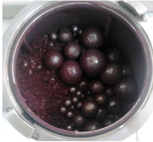
Figura III - 6 Molino de bolas – Coronta de maíz morado
