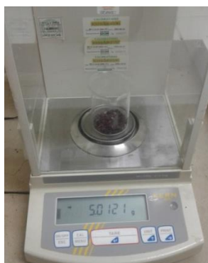
Figura III - 13 Pesado de la muestra Balanza Kern ABS
