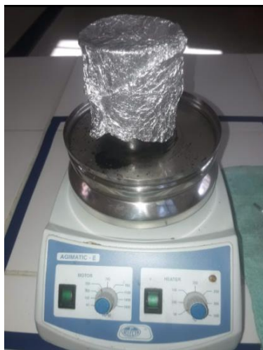
Figura III - 14 Extracción con solvente - Agitador magnético
