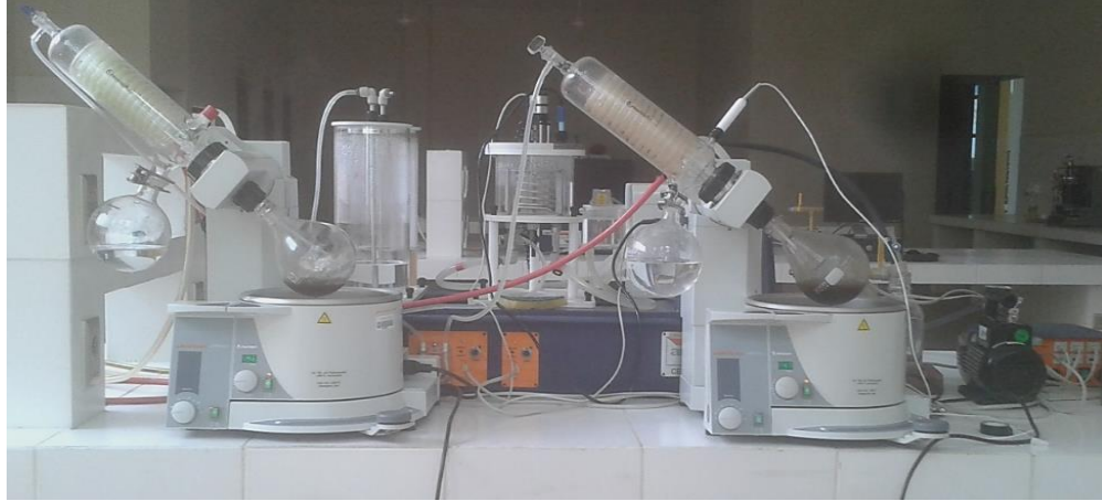
Fig. 3- 7 Concentración de la vinaza por doble efecto en los rotavapores
