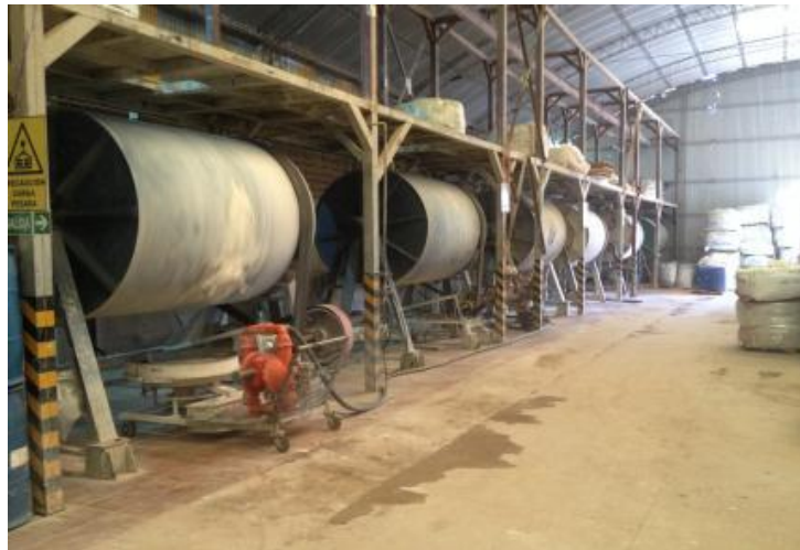
Foto N° 10 Molienda de engobe y esmalte
