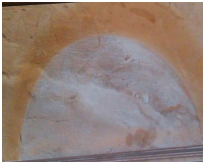
Foto N° 28 Pieza cerámica que presenta una mancha en su diseño
