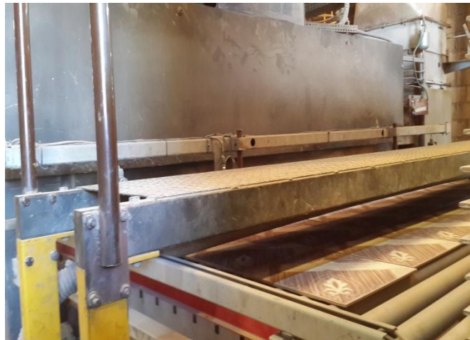
Foto N° 12 Ingreso de las piezas al horno
