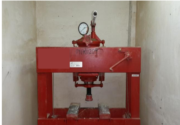
Foto N° 17 Prensa utilizada en laboratorio de cerámica Coboce
