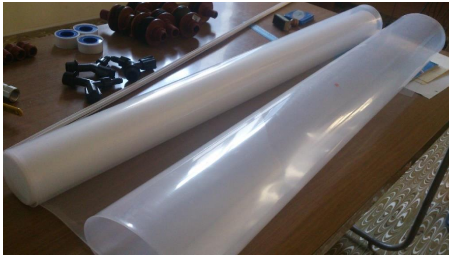
Figura ¡Error! No hay texto con el estilo especificado en el documento.-16 Polietileno de 250 micrómetros de espesor.
