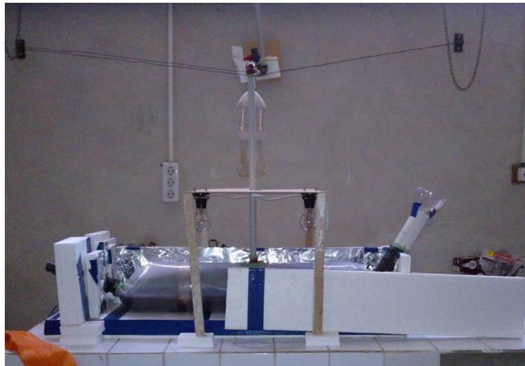
Figura ¡Error! No hay texto con el estilo especificado en el documento.-27 Biodigestor de polietileno tubular experimental.
