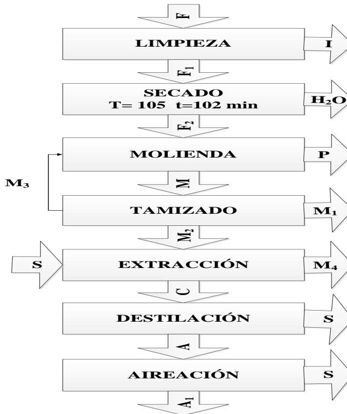
Diagrama de flujo para la extracción de aceite de semilla de mango.
