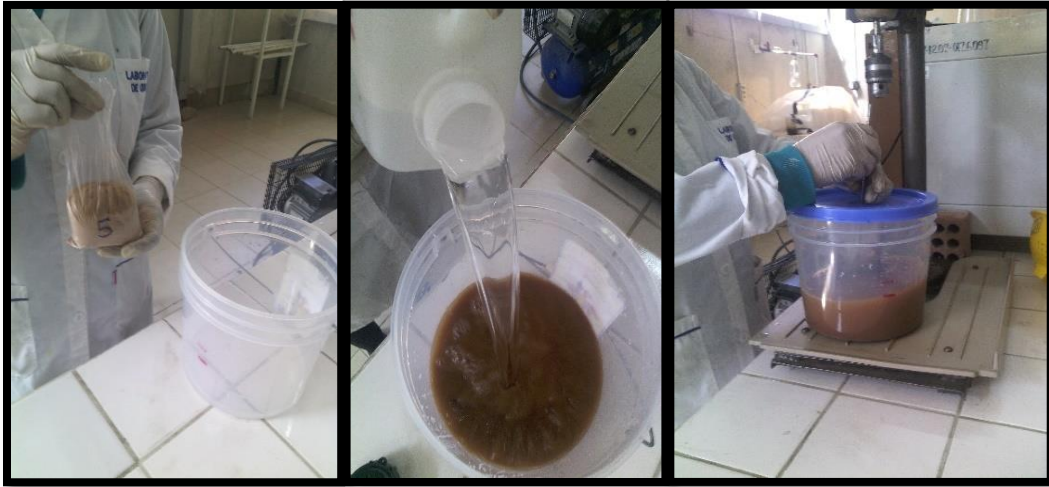
FOTO II-13 Montaje del equipo de agitación
