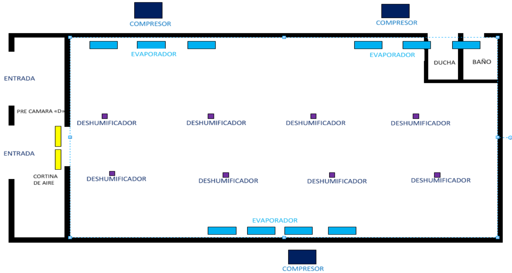
Figura A-IX.1 VISTA DE LA CÁMARA "D" PARA LA CONSERVACION DE GRANO
