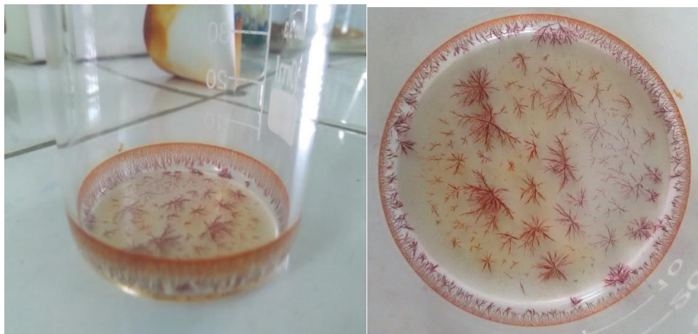
Figura 3-25 Cristalización de la solución evaporada de diclorometano
