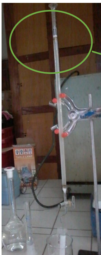
Figura 3-11 Columna empacada con silica gel
