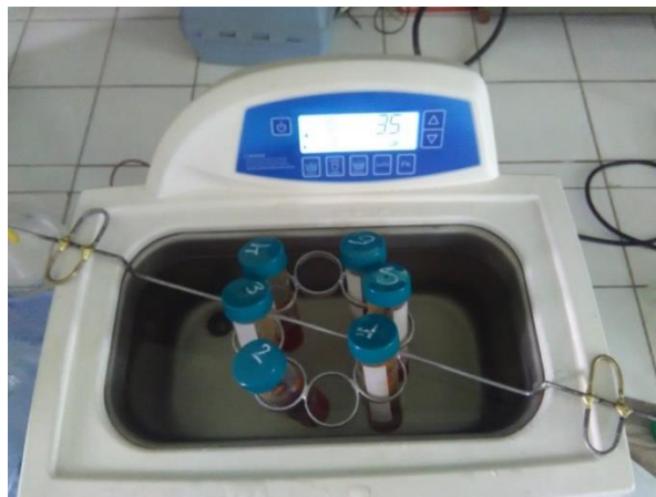
Figura 3-20 Extracción de la cáscara de tomate en el sonicador
