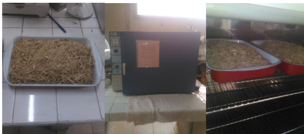
Secado del bagazo de caña de azúcar en el secador de bandejas.
