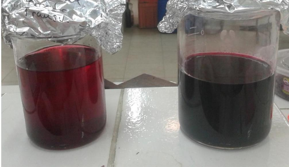
En la imagen izquierda se utilizó agua como solvente, mientras que en la derecha se utilizó alcohol etílico ambos sometidos a agitación durante 1 hora a 40°C. Como se puede observar, el poder extractor del alcohol como solvente es superior al del agua por lo que se lo elige como solvente en el proceso.
