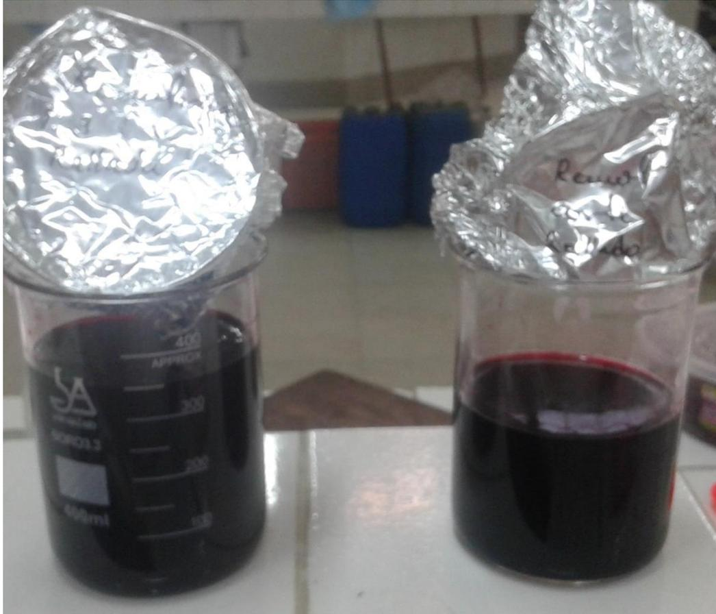
En esta imagen observamos en el lado izquierdo la cantidad de colorante extraído del proceso de compresión, mientras que en el lado derecho se observa el colorante obtenido del proceso de centrifugado. De esta manera, en base al rendimiento, se elige el proceso de extracción por compresión.
