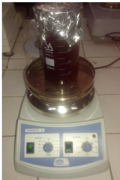
**Separación de colorante líquido y parte solida después de agitación**
